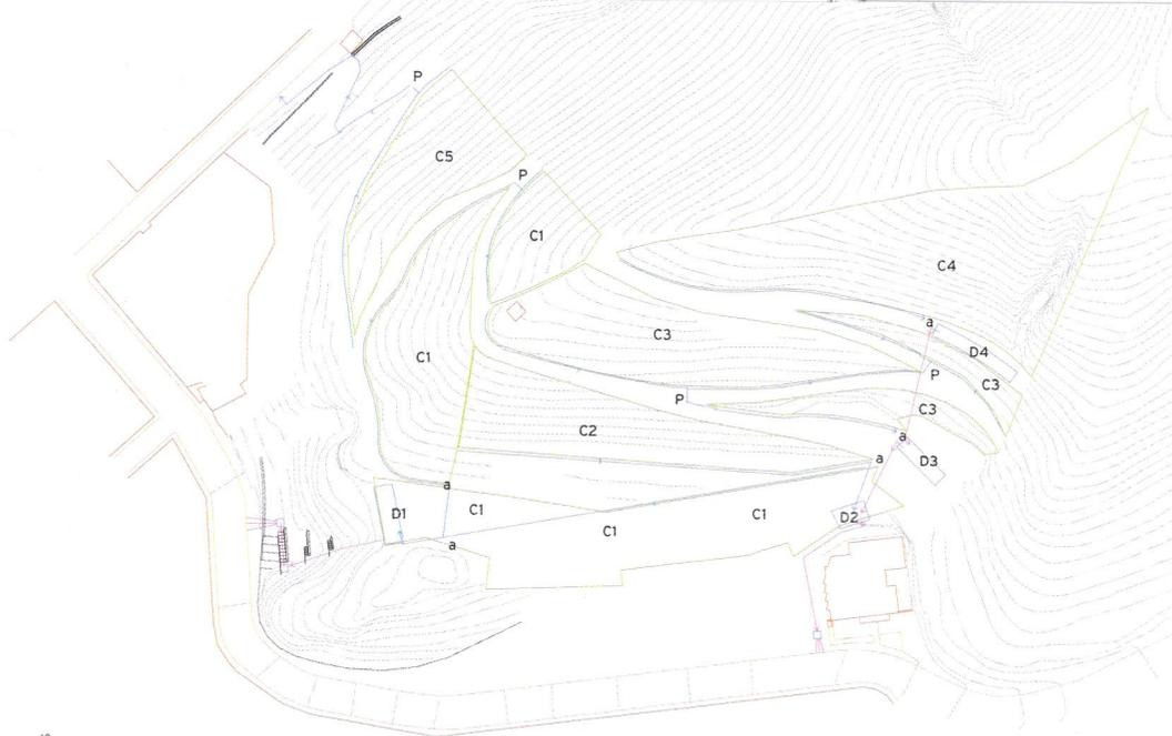
a > ARENERO | C3 > CUENCA DE RECOGIDA DE AGUA | D1 > DEPÓSITO 1: COTA ENTRADA AGUA 335,65 DIMENSIONES 16X5X2 | D2 > DEPÓSITO 2: COTA ENTRADA AGUA 335,5 DIMENSIONES 15X4X2 | D3 > DEPÓSITO 3: COTA ENTRADA AGUA 341,5 DIMENSIONES DEPÓSITO 16X4,5X1 | D4 > DEPÓSITO 4: COTA ENTRADA AGUA 355 DIMENSIONES 25X3X1,5 | P > PASO SUBTERRÁNEO DE AGUA (tubo hormigón diámetro 450 mm.)
